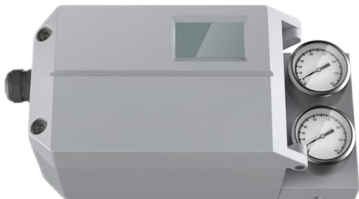
IP5500系列智能阀门定位器和气动执行器配套使用。通过接收来自控制系统的4-20mA DC电流信号得到阀位控制设定值，同时采集位置传感器信号得到实际的阀位值，两者通过控制软件的计算处理，从而控制气动执行机构的进气和排气，驱动阀位到达设定
